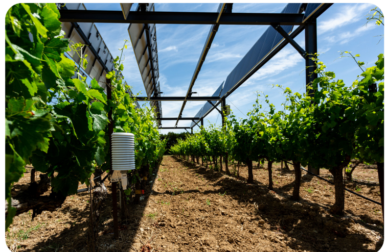
Dispositif expérimental sur vignes - Piolenc (84) ©Sun'Agri
